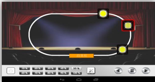
체육관 조명관리 화면 - 체육관의 조명의 밝기 및 구동 제어와 상태 표시
